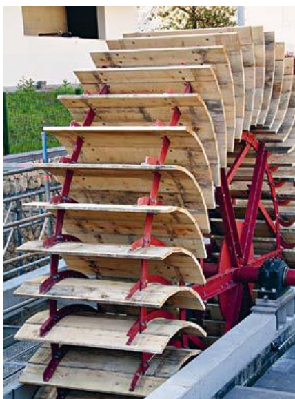
Mannheim-i, szennyvíztisztító Zuppinger típusú lapátkerék
