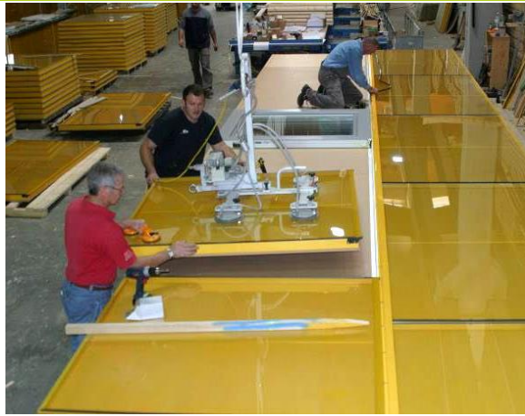
9.40 számú ábra: Homlokzati panelek gyártása és a bennük futó légtechnikai járat
