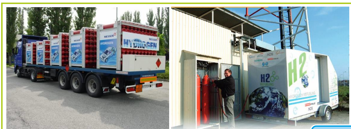
16.3 számú ábra: Bal oldalon: hidrogén közúti szállítása Magyarországon 338 ; jobb oldalon: hidrogén palackok feltöltése és a tüzelőanyag-cella karbantartása egy Budapest környéki mobil bázisállomáson 339
