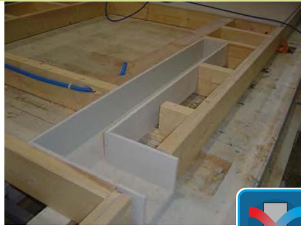
9.40 számú ábra: Homlokzati panelek gyártása és a bennük futó légtechnikai járat
