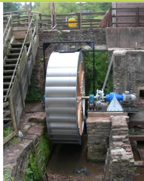
Dean-i örökség centrum, Egyesült Királyság 5kW-os felülcsapott vízkerék részben, mint látnivaló épült 2013-ban. (Nemesacél járókerék 1.4301 (V2A))
