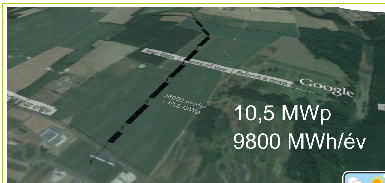
2.6 számú ábra: A javasolt K-Ny-i tájolású napelempark az Északi Ipari Park távvezetékei alatt
