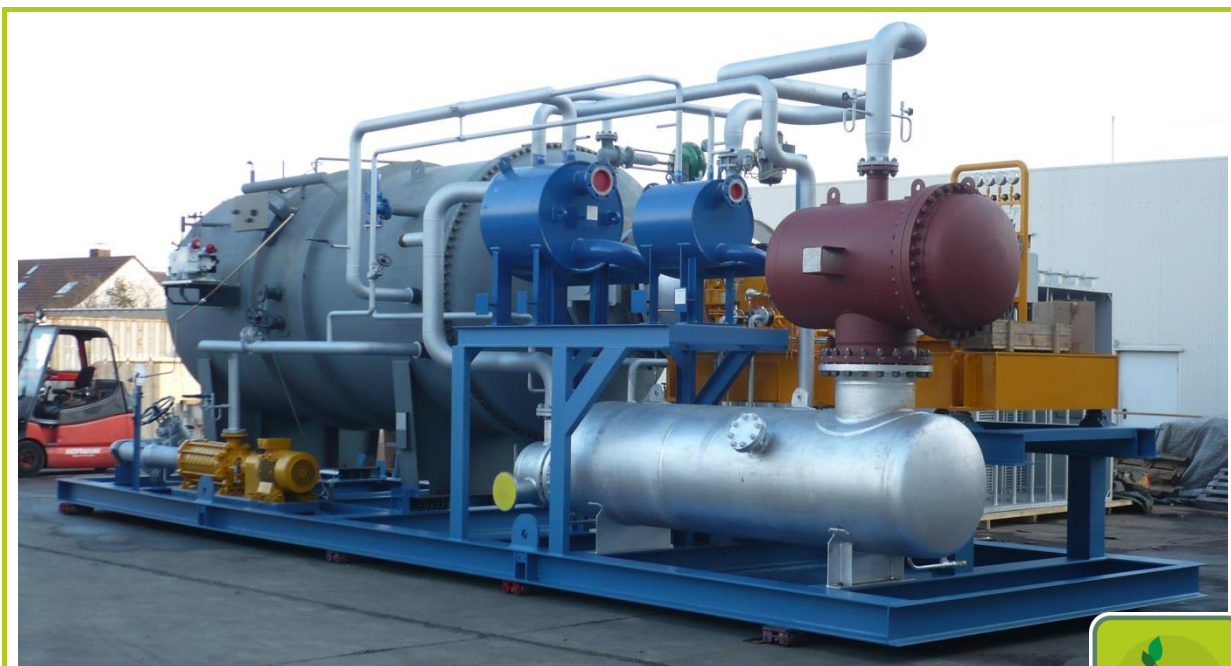
17.4 számú ábra: Egy 2 MW-os erőmű turbinarésze látható, világszerte kb. 270 ORC alapú biomassza erőmű működik
