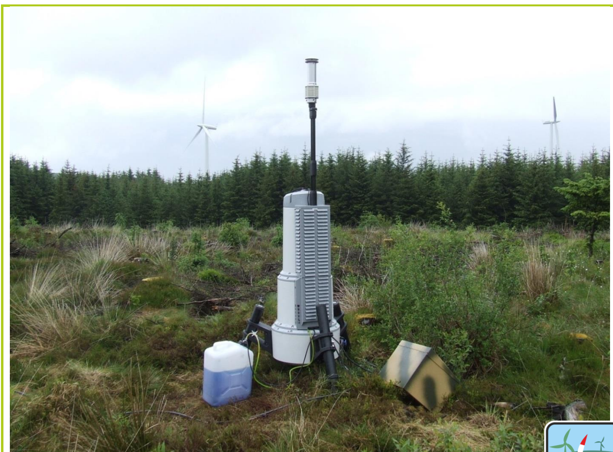
7.18 számú ábra: A Zephir lézeres szélmérője 119
