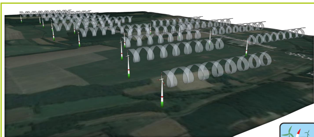
7.9 számú ábra: A Zalaegerszeg területére javasolt szélérőmű park 3D modellje a turbulencia hosszak jelölésével (Pálfi Sz.)
