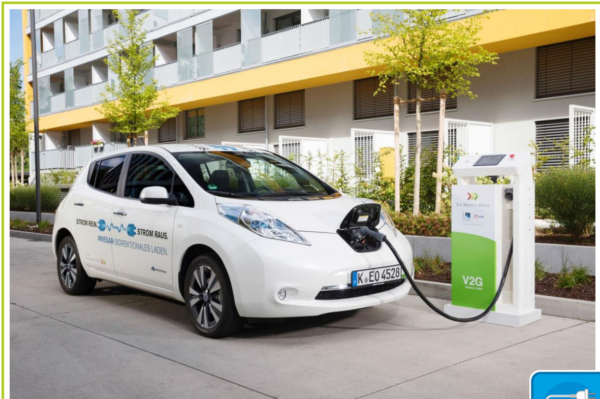
14.12 számú ábra: Egyenáramú kétirányú villámtöltő Münchenben Németországban, CHAdeMO csatlakozós járművekhez 265
